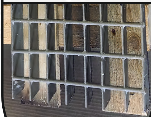
Kratka po usunięciu preparatu Antylak i farby
